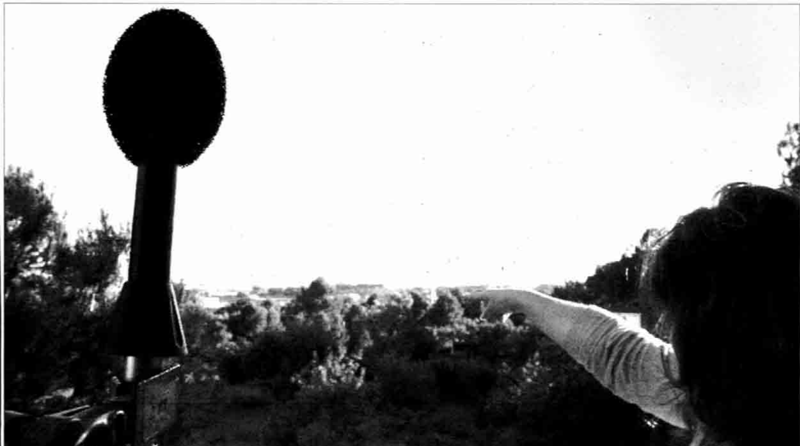
Aparatos instalados en las proximidades del by-pass actual para conocer el impacto acústico que genera la carretera. /IRENE MARSILLA
